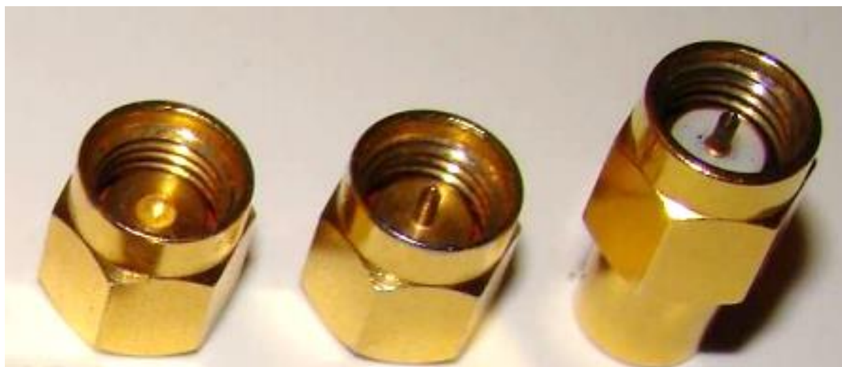
Fig. de mai sus arată aspectul kitului de calibrare: Conector deschis, în scurt și 50 Ohm. Sarcina de 50 Ohm primită cu NanoVNA-ul meu este diferită de cea din Fig. de mai sus.
