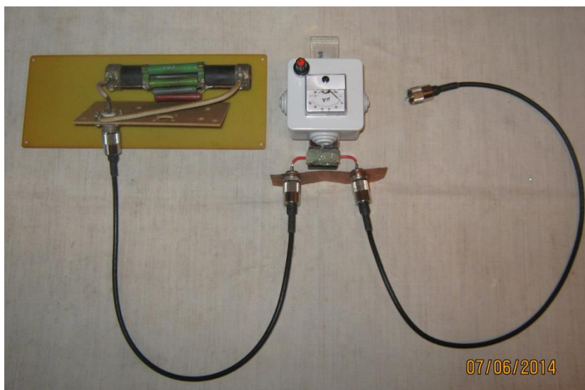
Structura de etalonare (nu zâmbiți la sarcina artificială... merge foarte bine!)
