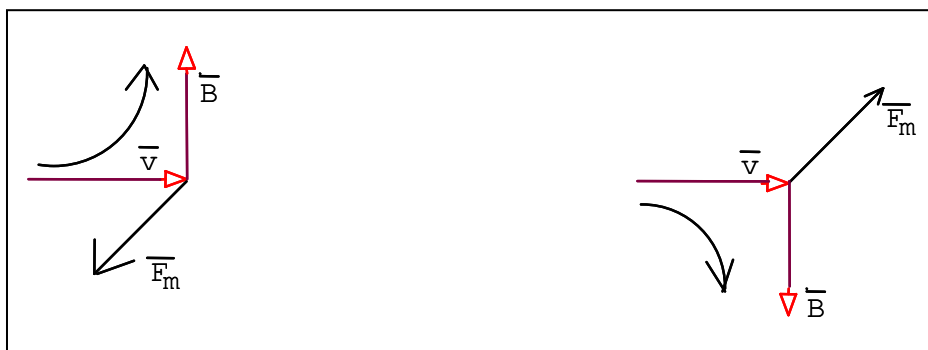
Fig.9.2. Metodă pentru determinarea direcției și sensului forței magnetice
