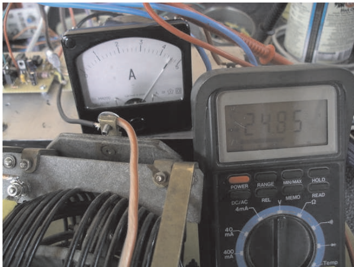
Inputul pentru a obține 100W după filtru
