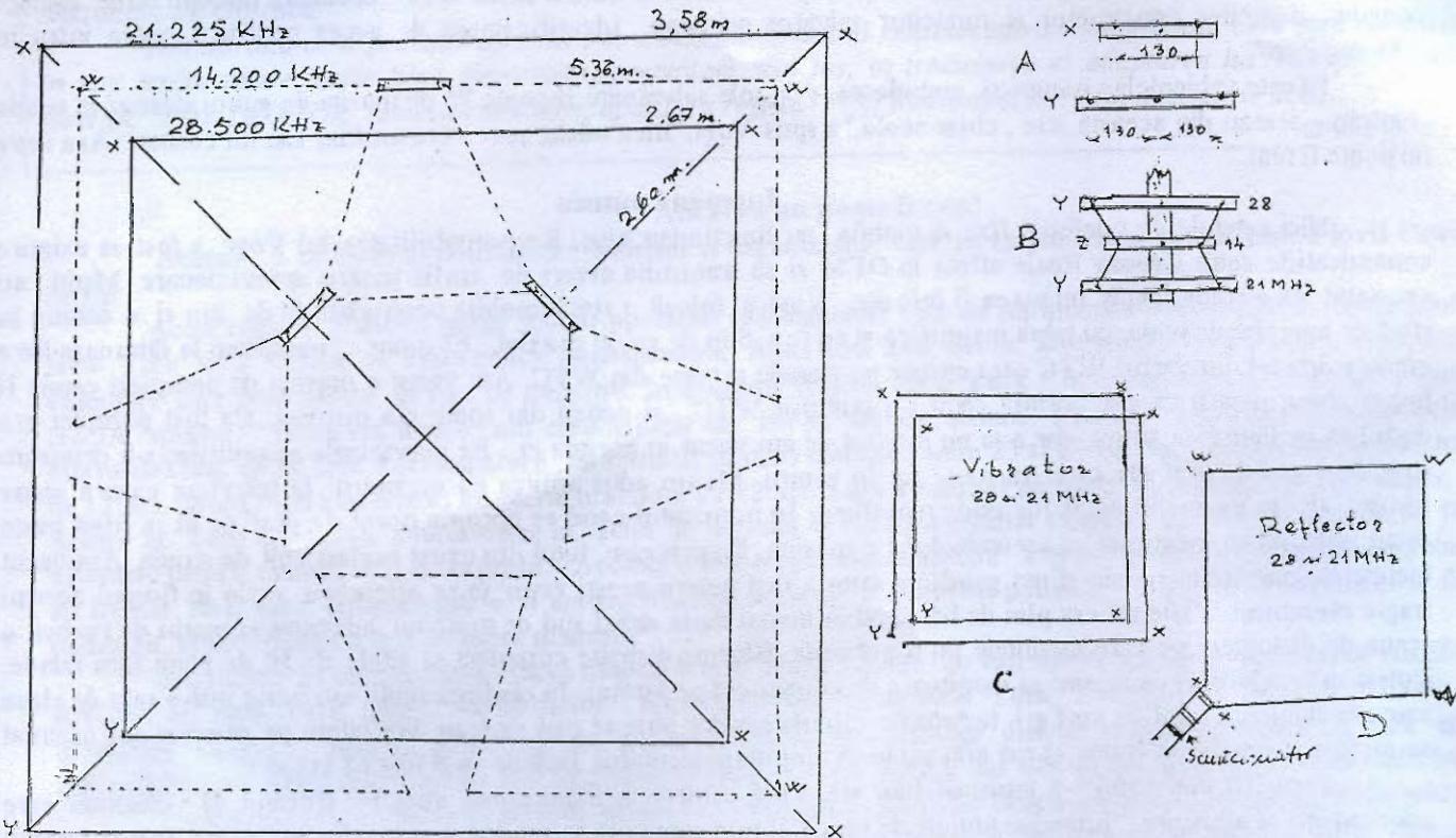
Vibratorii si reflectorii (vezi figura) se monteaza pe cate un cadru realizat din patru prajini (vezi tabelul), imbinate la mijloc cu doua corniere sudate (spate la spate) sub forma de cruce.
