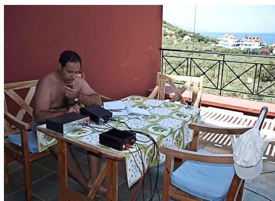
Am montat antena cu radialul, am pornit statia si am facut primele reglaje. Tunerul acorda antena destul de bine in benzile superioare incepand cu 14MHz, asa ca am incercat sa fac si primele QSO-uri cu diferite statii. In prima zi am lucrat in tara cu YO5QAW pe care il auzeam excelente avand in vedere conditiile.
